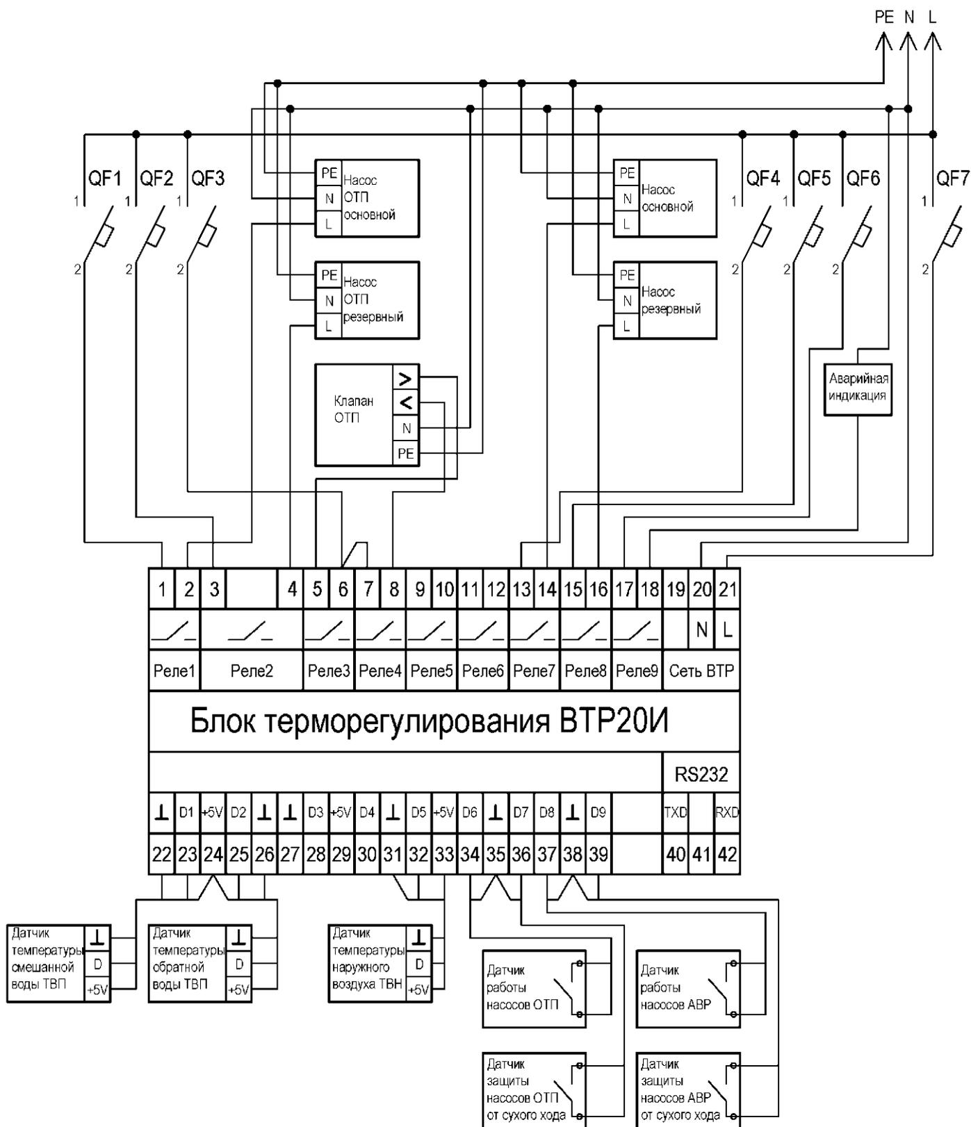
**Рисунок В.5-Схема подключения регулятора ВТР 20И (программа 15) в системе управления контуром ОТП и контуром АВР насосов**
