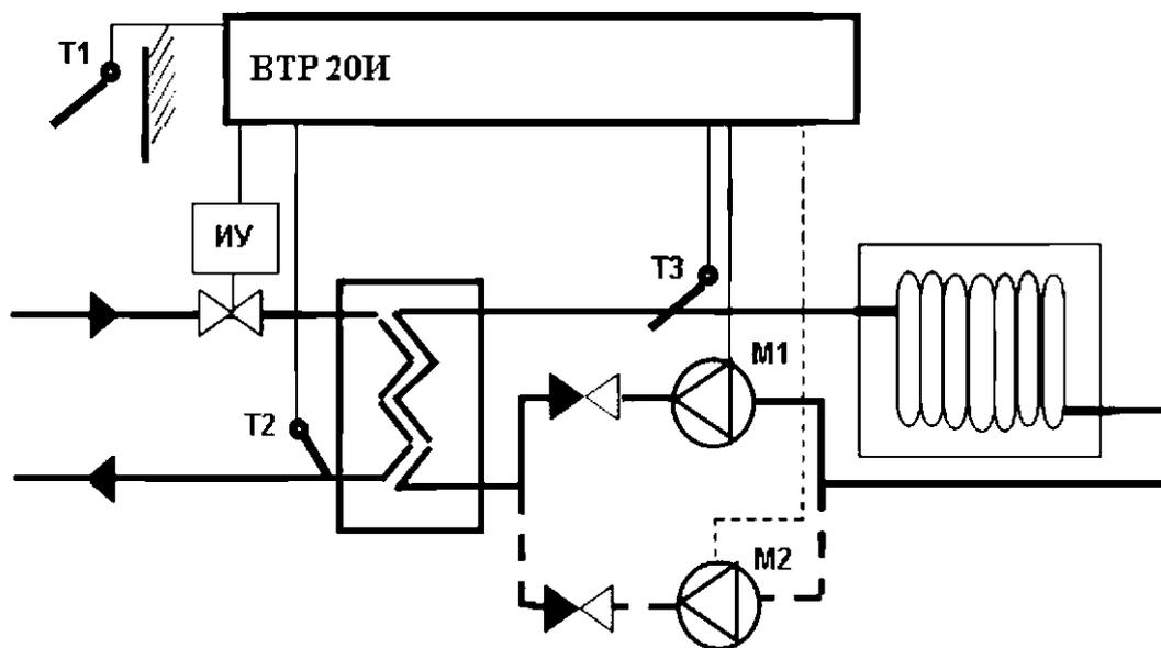
**Рисунок Б.1 – Монтажная схема регулятора ВТР 20И (программа 10) в системе управления одним независимым контуром отопления**
