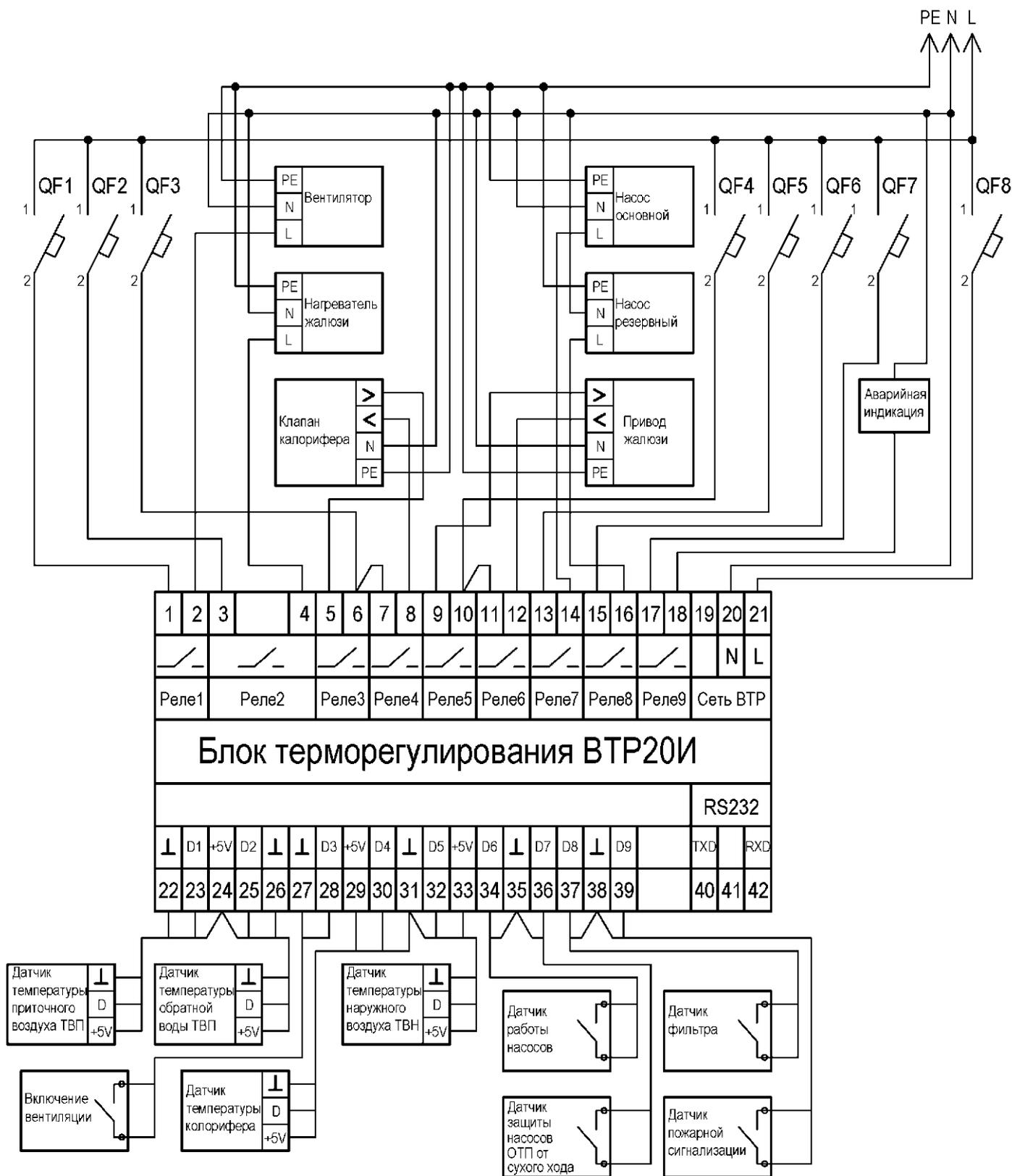
**Рисунок В.10-Схема подключения регулятора ВТР 20И (программа 33) в системе управления приточной вентиляцией**
