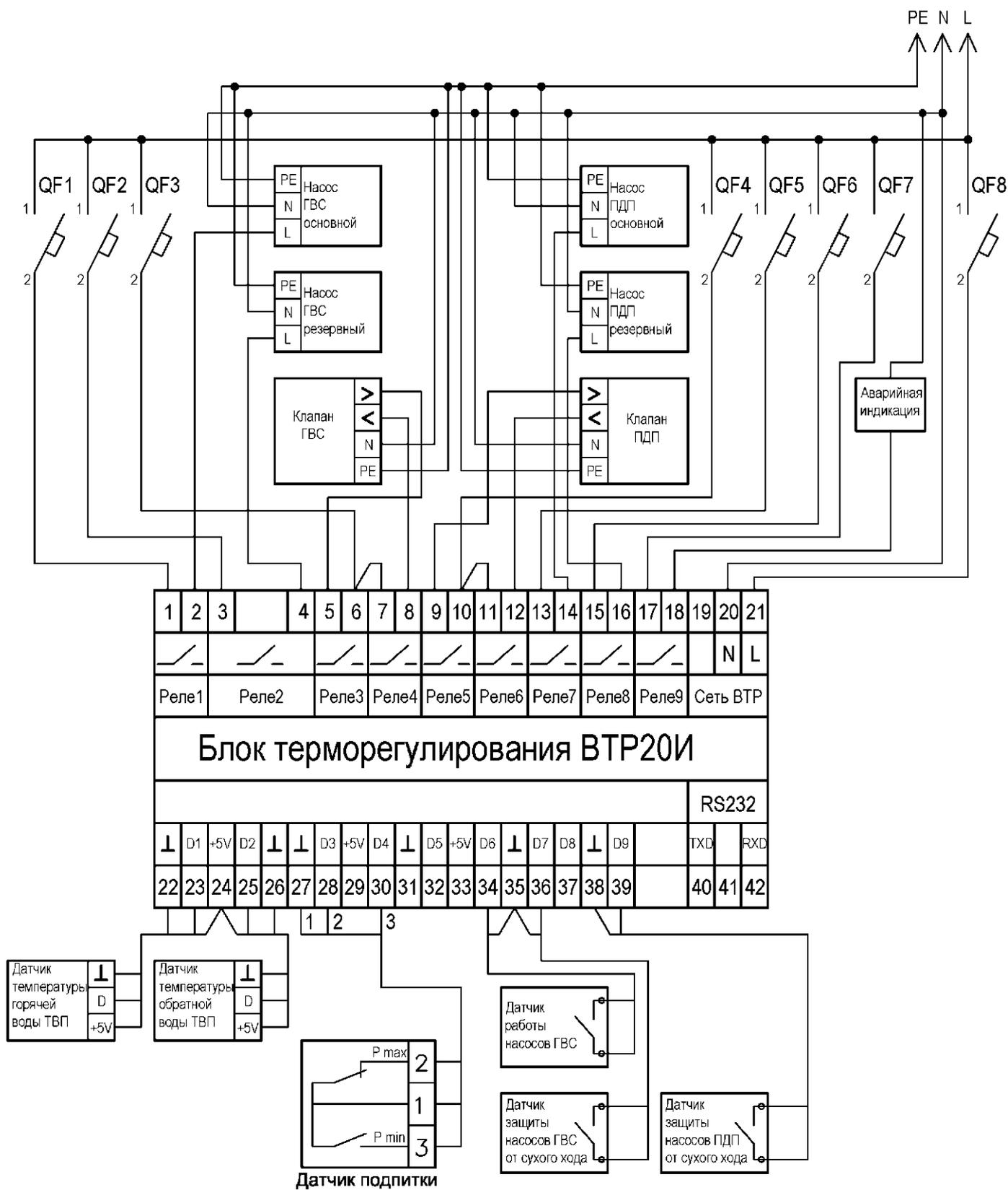
**Рисунок В.8-Схема подключения регулятора ВТР 20И (программа 24) в системе управления контуром ГВС и контуром подпитки**
