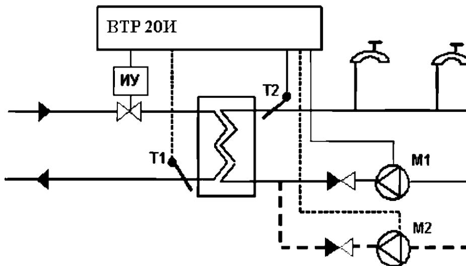
Рисунок Б.3 - Монтажная схема регулятора ВТР 20И (программа 20) в системе управления одним контуром ГВС
