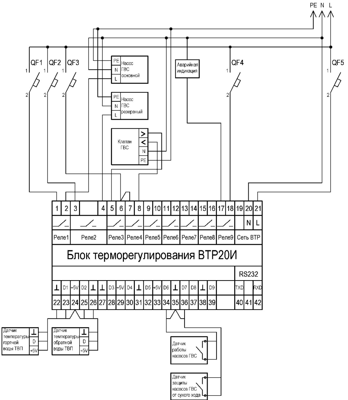
**Рисунок В.6-Схема подключения регулятора ВТР 20И (программа 20) в системе управления одним контуром ГВС**
