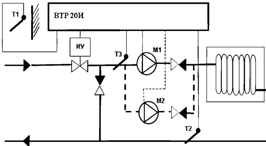
**Рисунок Б.2 - Монтажная схема регулятора ВТР 20И (программа 10) в системе управления одним зависимым контуром отопления**
