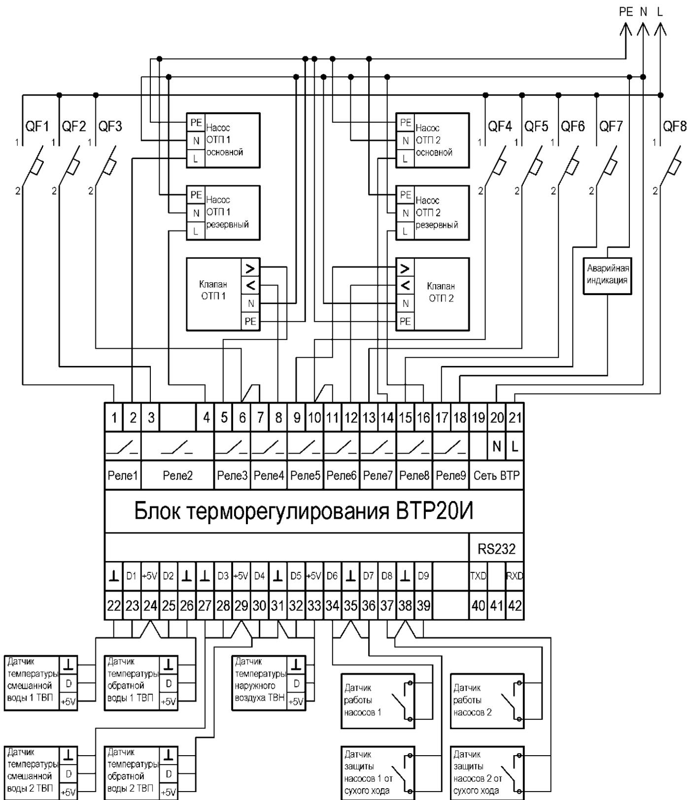
**Рисунок В.2-Схема подключения регулятора ВТР 20И (программа 11) в системе управления двумя контурами ОТП**
