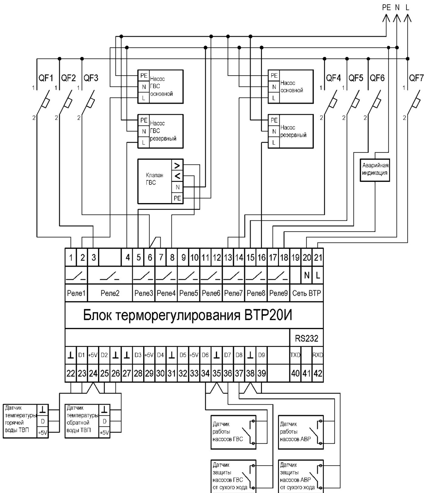
**Рисунок В.9-Схема подключения регулятора ВТР 20И (программа 25) в системе управления контуром ГВС и контуром АВР насосов**
