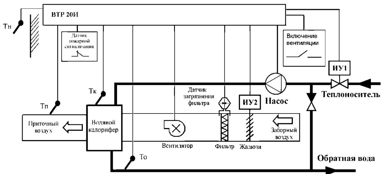
Рисунок Б.4 - Монтажная схема регулятора ВТР 20И (программа 33 ВЕНТ) в системе управления приточной вентиляцией
