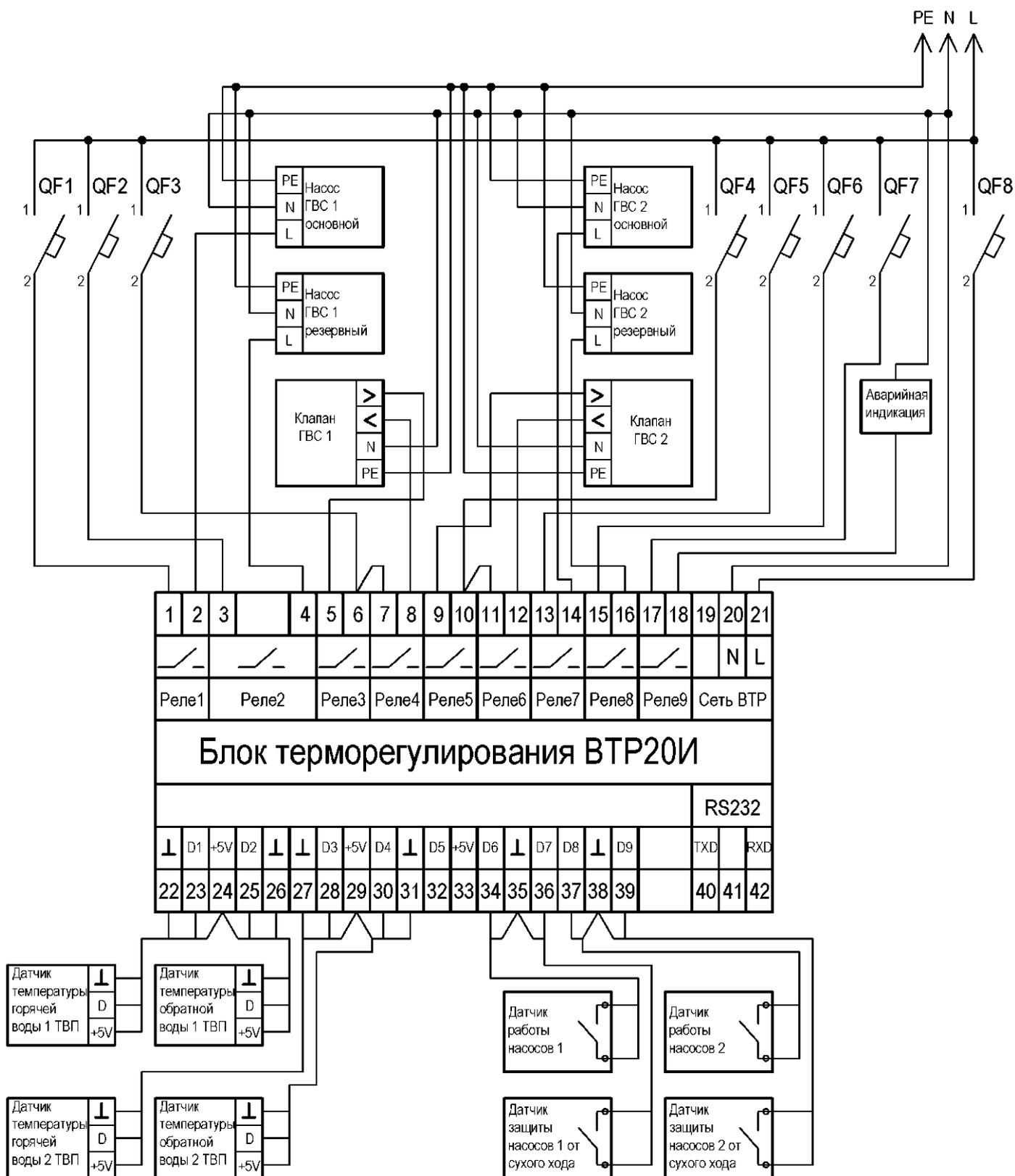
**Рисунок В.7-Схема подключения регулятора ВТР 20И (программа 22) в системе управления двумя контурами ГВС**
