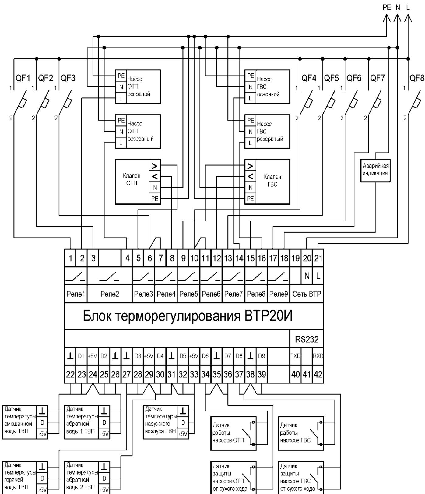
**Рисунок В.3-Схема подключения регулятора ВТР 20И (программа 12) в системе управления контуром ОТП и контуром ГВС**
