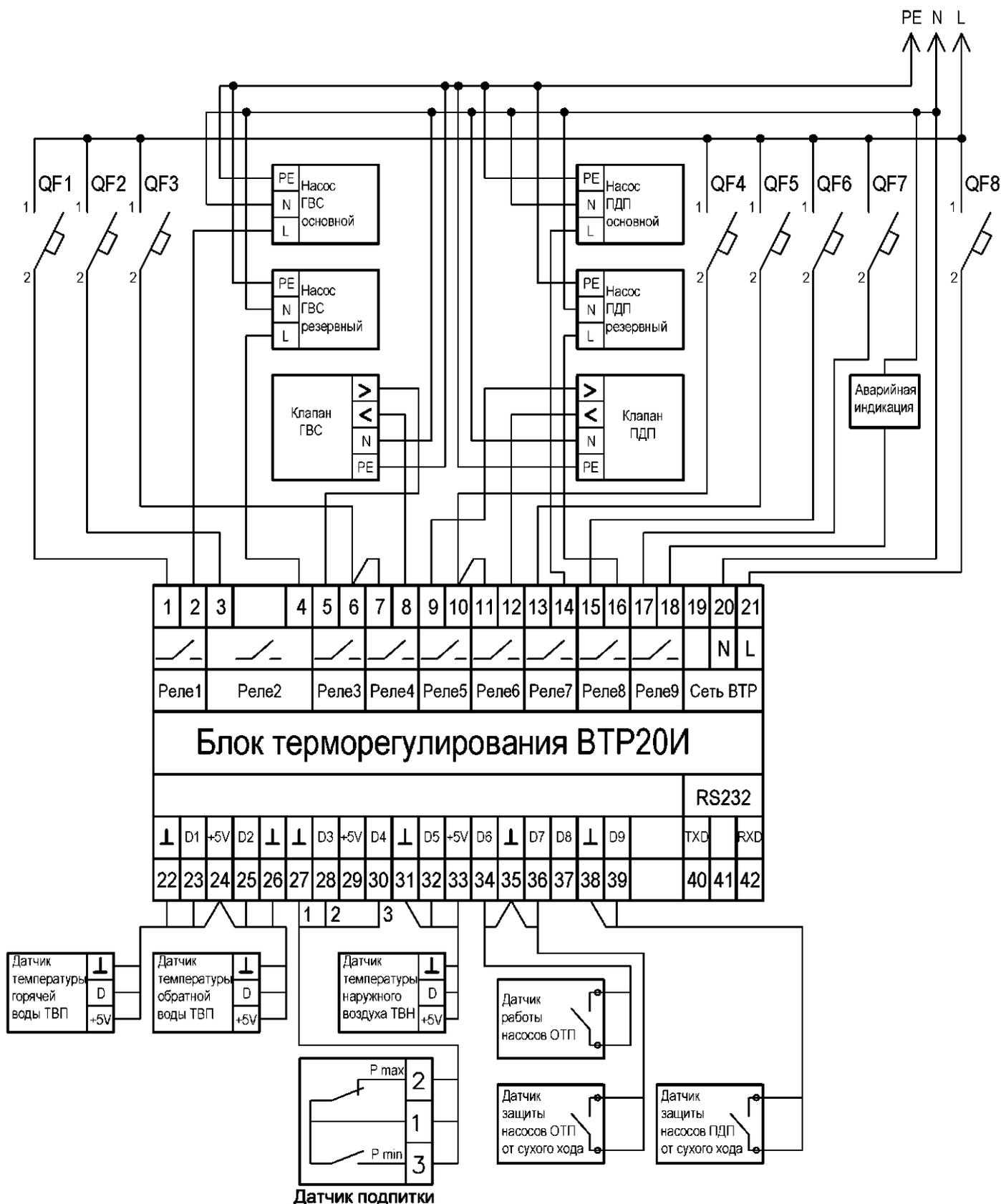
**Рисунок В.4-Схема подключения регулятора ВТР 20И (программа 14) в системе управления контуром ОТП и контуром подпитки**
