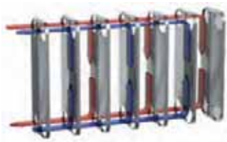
Одноходовой каналы соединены параллельно
